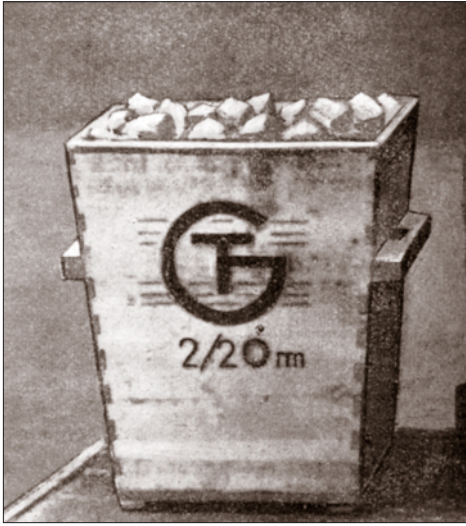
Ryc. 5. Skrzynia o pojemności 2/20 mp jako miara przestrzenna (obok jej wymiary w cm) do odmierzania zrębków drewna generatorowego („Las i Drewno” 1942)
