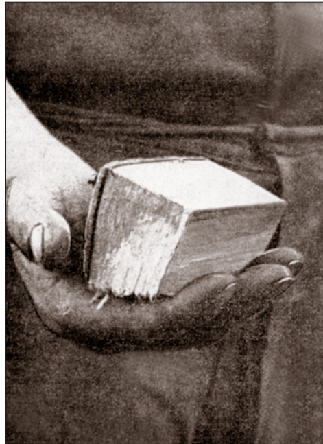
Ryc. 4. Kształt i wielkość kawałka drewna generatorowego („Las i Drewno” 1942)
